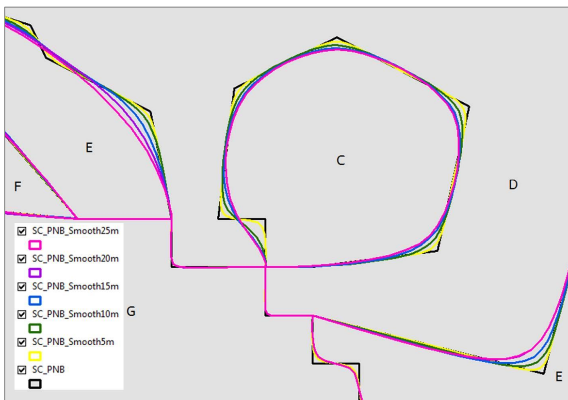
ภาพที่ ๒-๖ ผลลัพธ์ของเส้นขอบเขตของรูปปิดที่เกิดขึ้นจากการกำหนดระยะทางของการย้ายส่วนที่ใช้คำนวณจุดใหม่ (Smoothing tolerance) เท่ากับ ๕ เมตร ๑๐ เมตร ๑๕ เมตร ๒๐ เมตร และ ๒๕ เมตร
